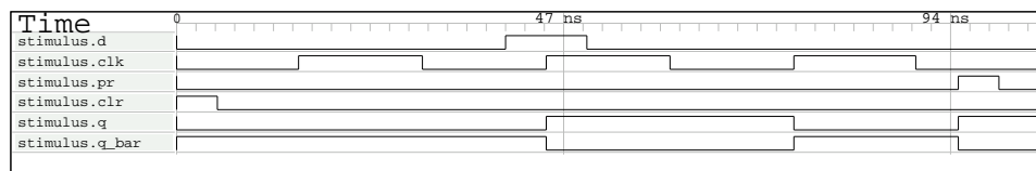
Slika 3.13: Rezultati simulacije preset-clear D flip-flopa.
