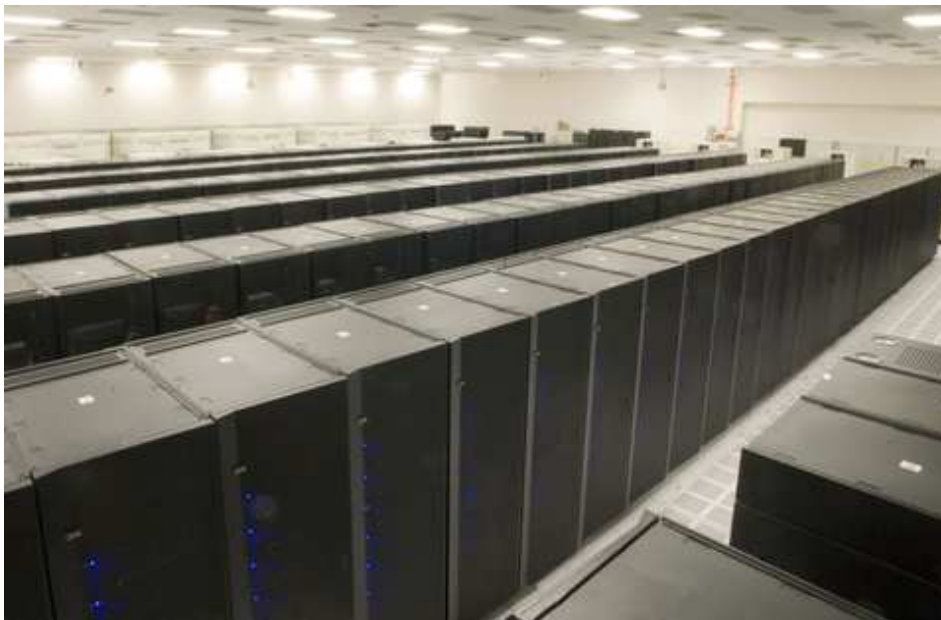
Slika 12: Roadrunner – BladeCenter QS22/LS21 - prvi superračunar sa brzinom većom od 1 Pflops-a
